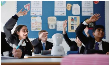
挪威“不孤立”科技公司研发了一款名为AV1的机器人。这款机器人搭配了可旋转摄像头以及麦克风,因病或者其他原因缺席的学生可以控制机器人,用其代替自己的眼睛和耳朵进行远程上课,用“举手”功能,让学生能在课堂回答提问(如图)。此外,学生还可以用机器人的面部显示不同的表情符号表达自己的情绪。
