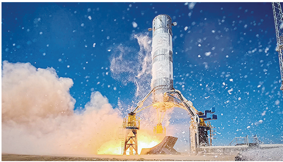
图为朱雀三号VTVL-1可重复使用垂直起降回收试验箭。蓝箭航天供图
