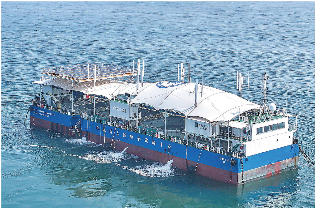
近日，由中国水产科学研究院渔业机械仪器研究所与荣成市携手打造的“渔机1号”深远海养殖综合试验平台在山东省荣成市北部海域成功布放并投入运营。 据了解，“渔机1号”平台作为全国首座集深远海养殖新品种开发、工业化养殖模式研究及试验观测等多功能于一体的封闭式舱养系统综合试验平台，设有4个大型及20个小型封闭式试验舱，养殖水体达5000立方米，能够满足多样化的深远海养殖实验需求。 图为8月23日拍摄的“渔机1号”深远海养殖综合试验平台(无人机照片)。 新华社发(李信君 摄)
