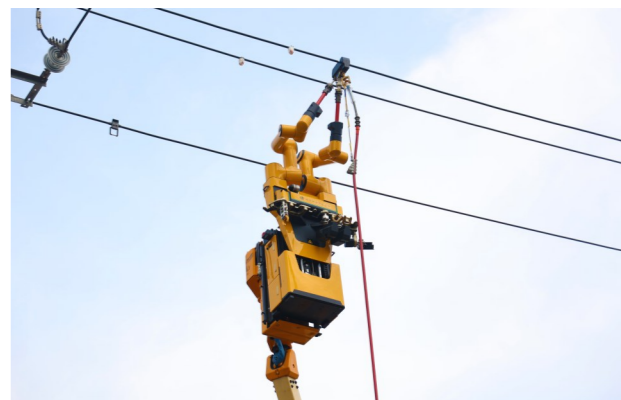
新一代配网带电作业机器人亮相。株洲日报全媒体记者/任远 通讯员/刘杰 摄
