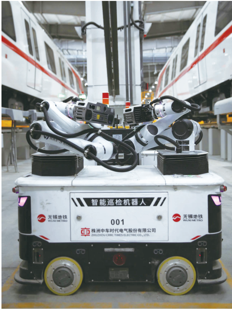
中车株洲所的智能列检机器人每天都在为无锡 S1 线开展巡检。企业供图
