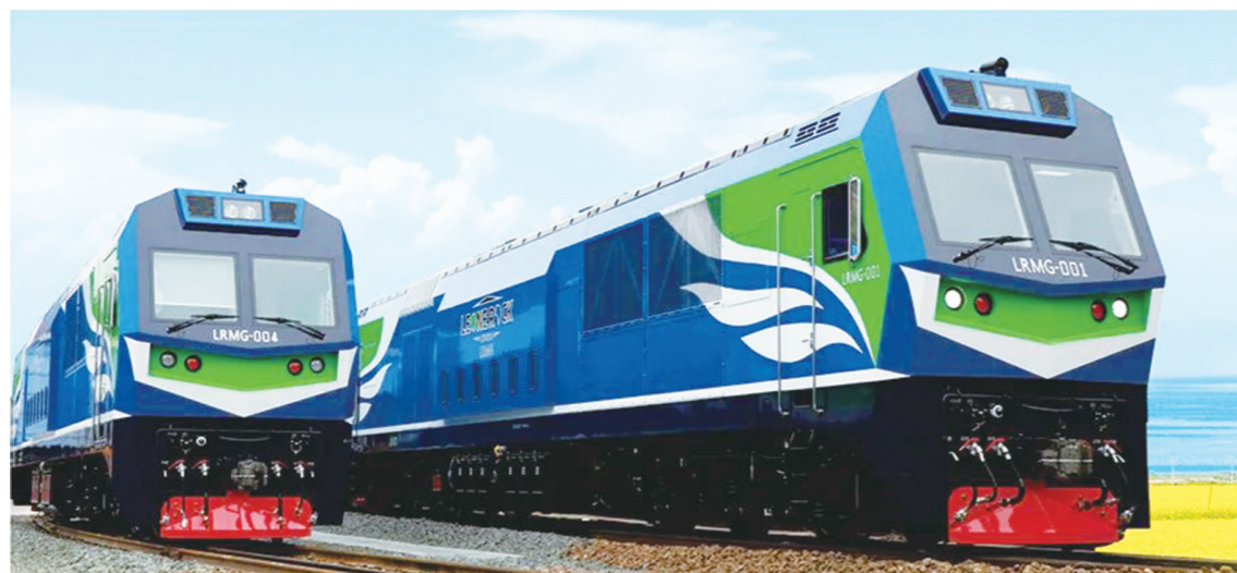
中车资阳公司自主研发的全球最大功率窄轨交流传动内燃机车。企业供图
