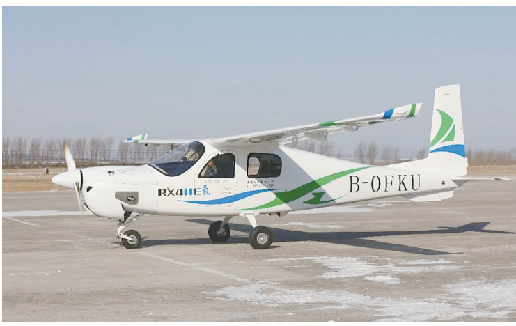
世界首款四座氢内燃飞机原型机。沈阳航空航天大学宣传部 供图
