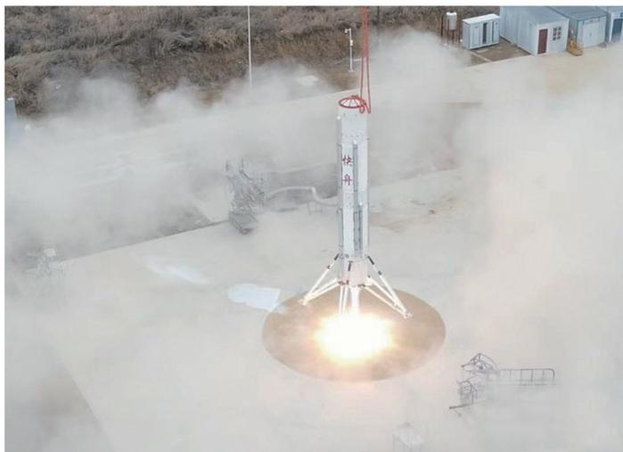
1月26日15时，航天科工火箭技术有限公司自主研发的快舟火箭可复用技术试验箭顺利完成垂直起降试验，本次试验采用其自主研发的液氧甲烷发动机，飞行时间22秒，空中悬停9秒，悬停高度精度0.15米，试验箭
