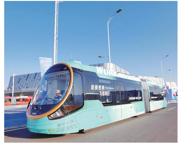
中车株机公司研发的新一代超级虚拟轨道列车(SRT)。 企业供图
