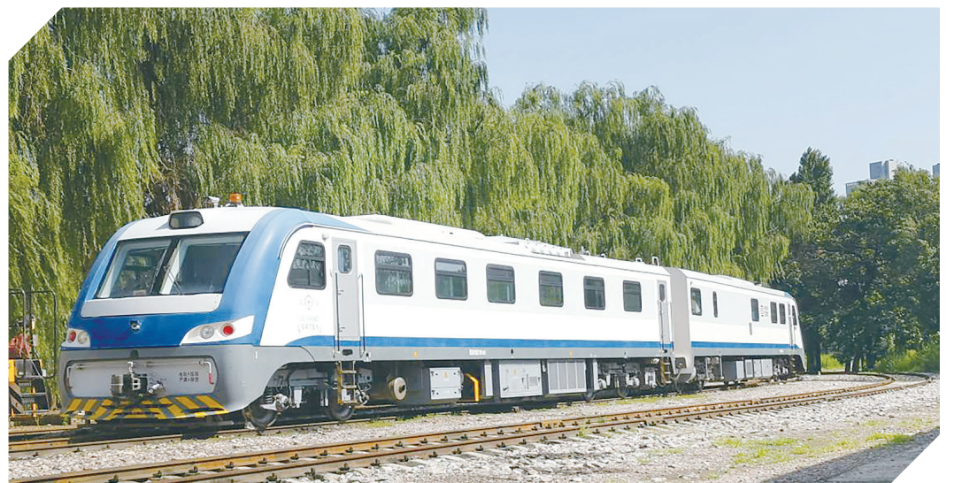
时代电子自主研发的钢轨探伤车在现场作业。受访企业供图
