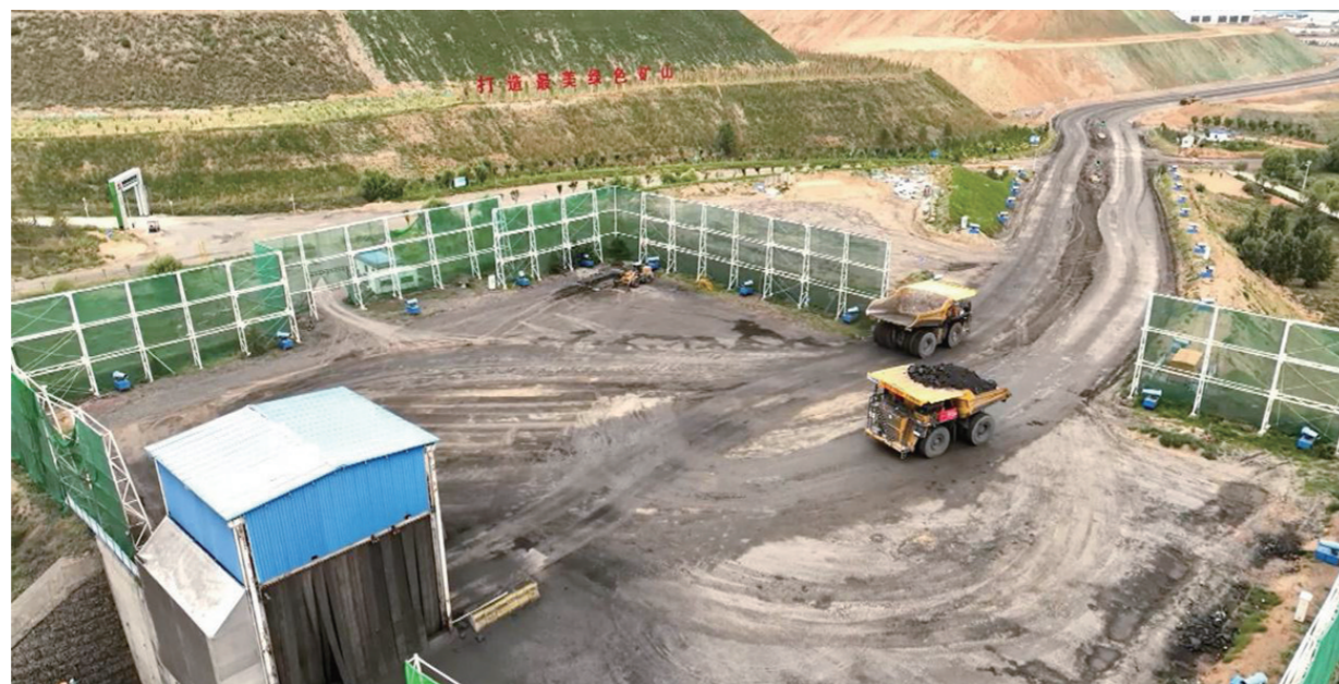
无人驾驶矿卡在破碎站卸煤的场景。 企业供图
