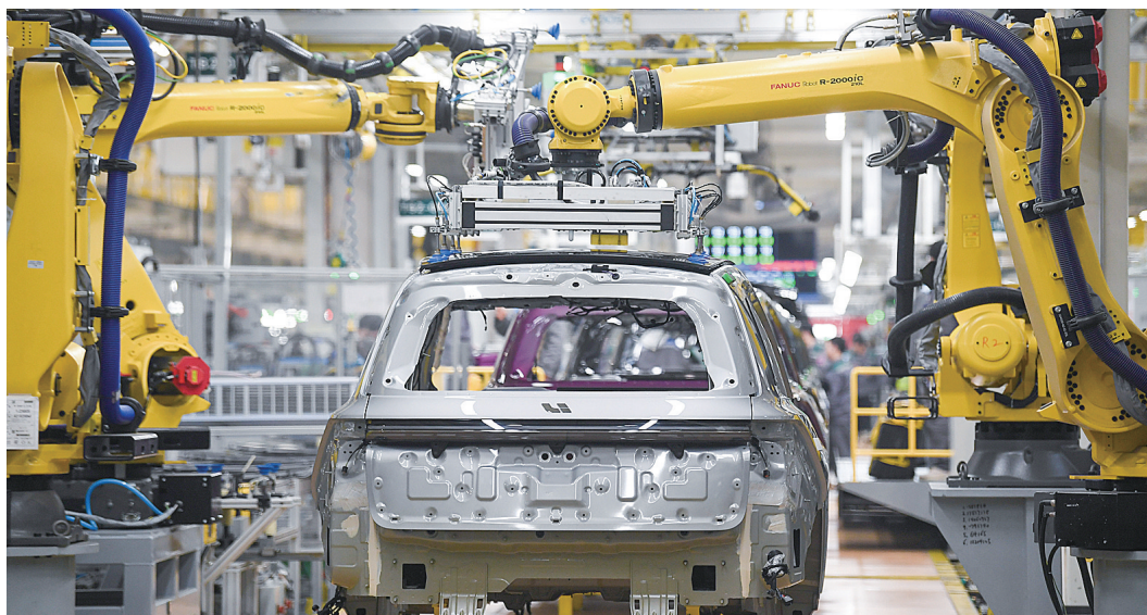
理想汽车常州基地的机器人在安装车窗玻璃(2月15日报)。新华社发
