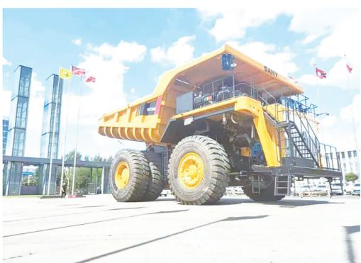
搭载了时代电气核心牵引系统的SET240S电动轮矿车。 企业供图
