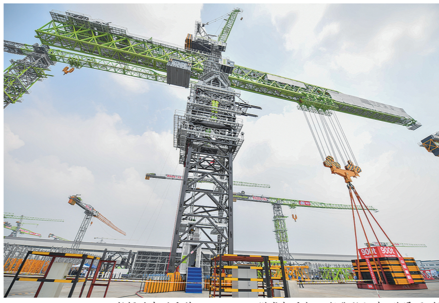
20日拍摄的中联重科R20000-720塔式起重机。新华社记者 陈泽国 摄
