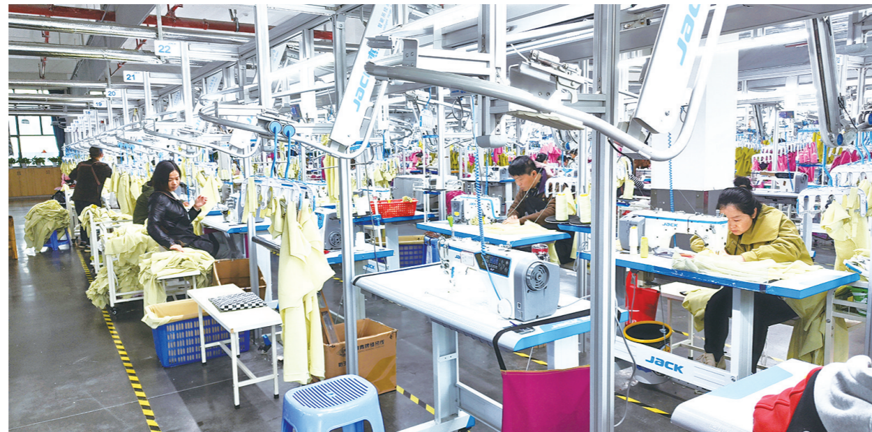
智能吊挂系统通过轨道方式将服装送向缝制车间。记者/杨凌凌 摄
