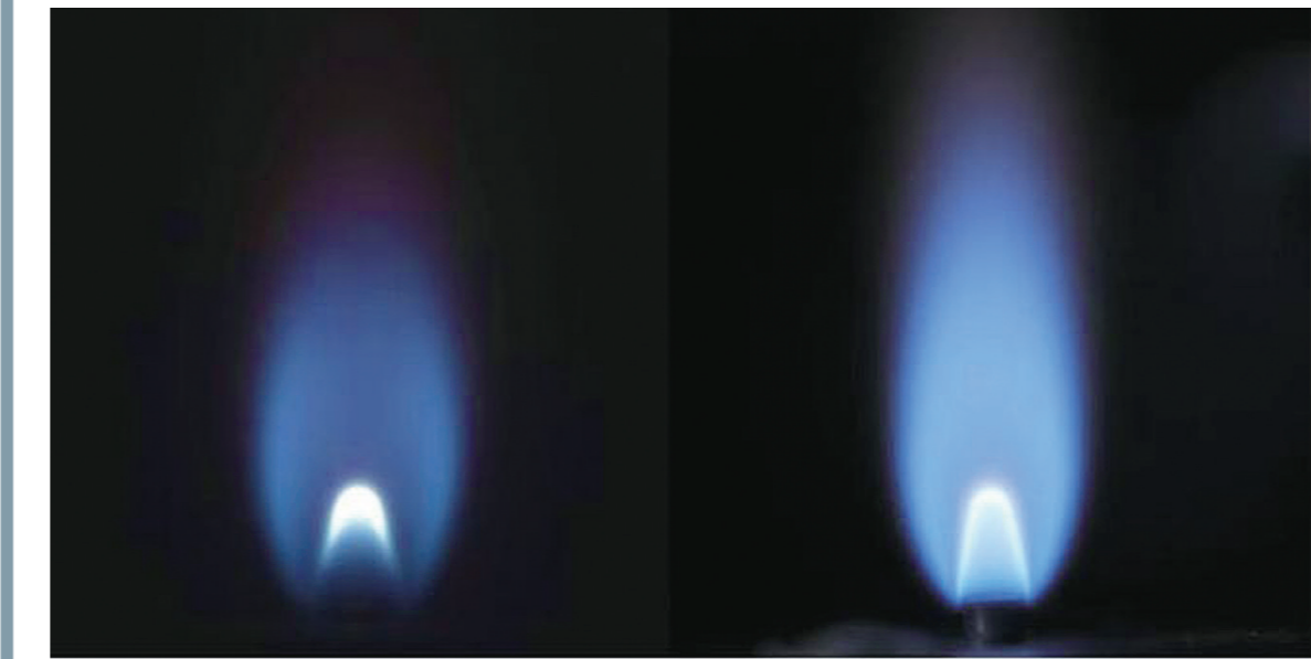
空间站燃烧科学实验柜甲烷燃烧图像(左)与地面同工况甲烷燃烧图像(右)。(中国科学院工程热物理研究所、清华大学燃烧能源中心供图)
