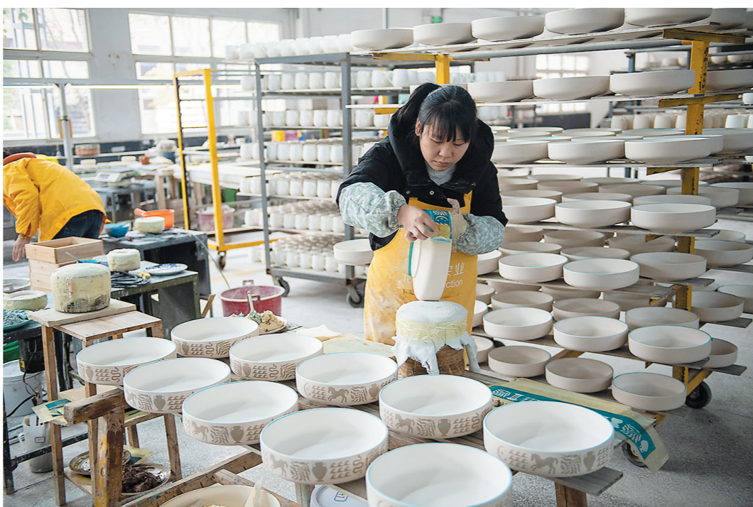
2月22日,在醴陵陶润实业发展有限公司生产车间,工作人员在给瓷器半成品做丝网印刷。醴陵瓷器是湖南省株洲市醴陵市特产,醴陵陶瓷产业是湖南先进制造业集群。目前,醴陵市现有陶瓷产业链上下游企业1500多家,其中规模以上企业345家,从业人员近20万人,产品包括日用瓷、工业瓷、艺术瓷三大类4000多个品种,去年陶瓷产业集群产值超700亿元。
