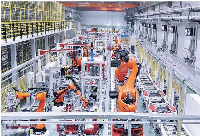
中车株洲电机公司的城轨标动牵引电机智能组装机。企业供图
