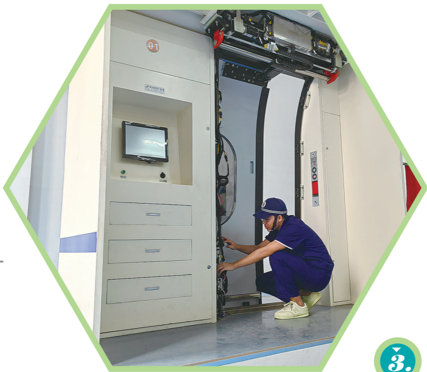
湖南铁路科技职业技术学院学生在检修动车组车门。 记者/孙晓静 摄
