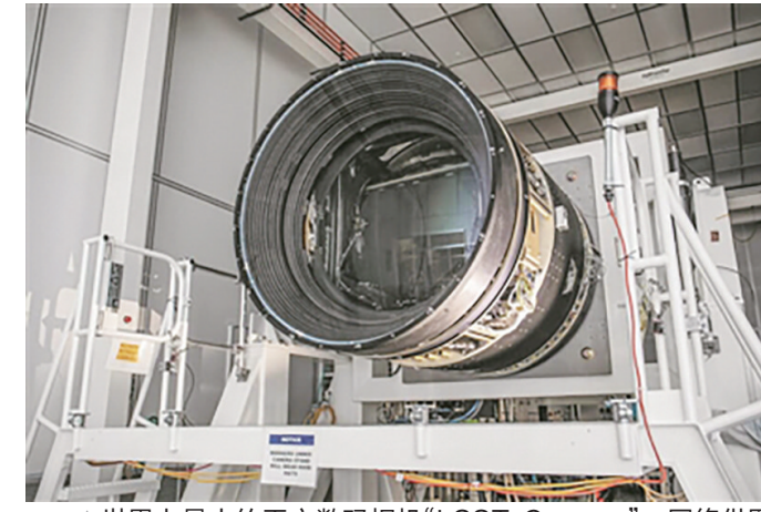
▲世界上最大的天文数码相机“LSST Camera”。网络供图
