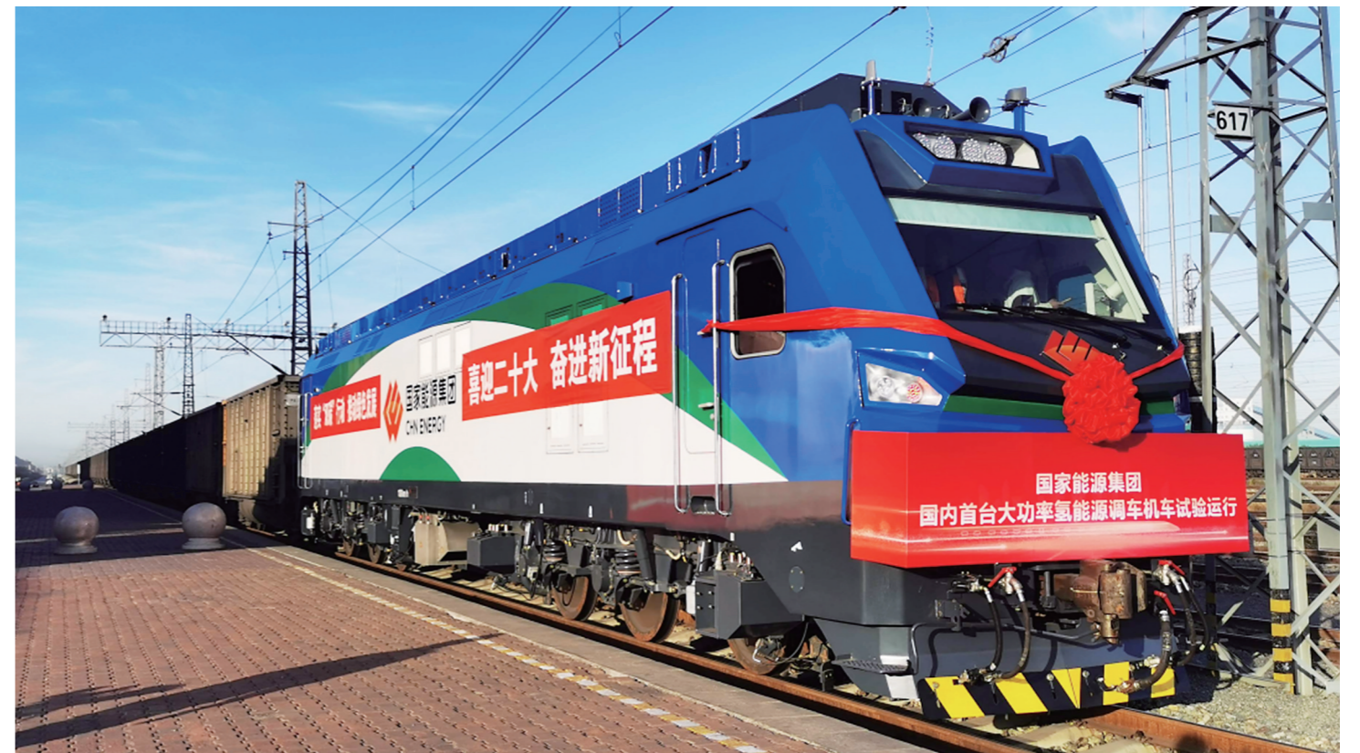
▲近日,由中车株洲电力机车有限公司和新朔铁路合作研制的国内首台大功率氢能源动力调车机车,在新朔铁路开始运行试验,这标志着我国重载铁路大功率氢能源动力装备的市场化运用取得重大突破,填补了国内行业空白。图为准备运行试验的调车机车。 企业供图
