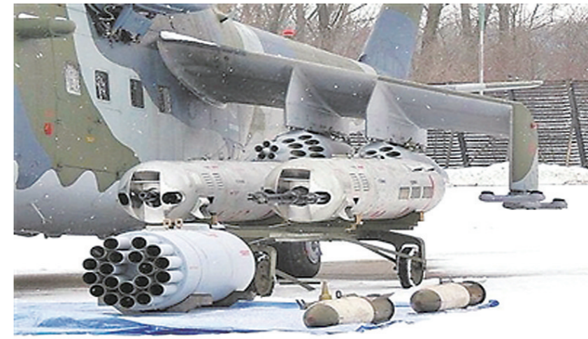
▲俄军GUV-8700对地攻击机炮吊舱(资料图)
