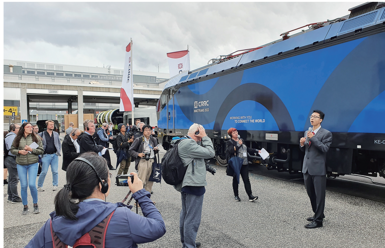
▲当地时间9月20日,在2022德国柏林轨道交通技术展览会上,中车株洲电力机车有限公司研制的出口欧洲多流制电力机车精彩亮相。这台机车外形酷似野牛,牵引功率5600千瓦,起动牵引力300千牛,最高运行时速140千米。该机车能快速充电,且适用多种供电制式,能够满足沿线不同国家、不同供电制式的铁路运输需求,助力欧洲铁路实现互联互通。图为该机车亮相柏林展。
