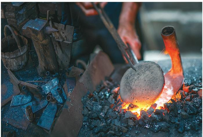
回炉的时候,需要铁盖控制氧气,进而控制热度。
