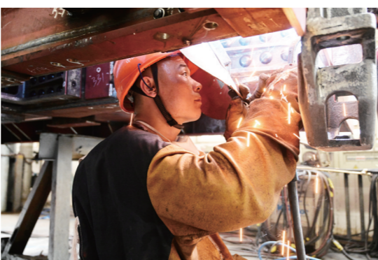
▲中车株洲车辆有限公司焊工周培正在对锁头部件焊接。
