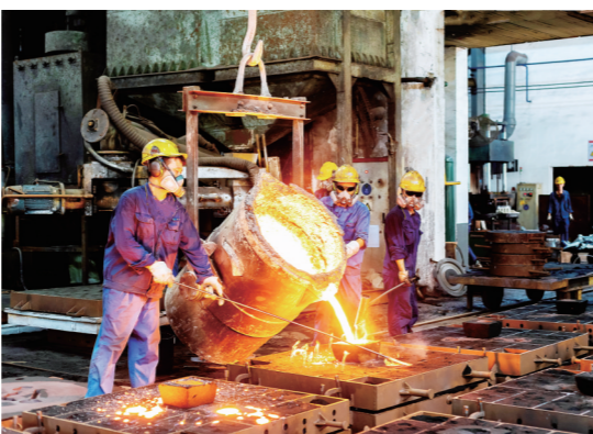
▲联诚集团铸业车间浇注现场,铸造班员工正在对HXD1型机车制动盘进行浇注作业。
