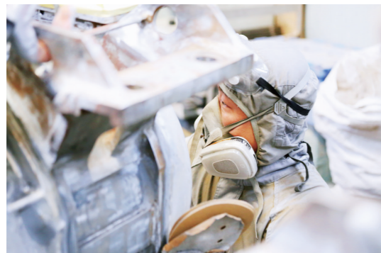
▲联诚集团新材料公司涂装车间,员工全副武装对电机产品进行涂装打磨。
