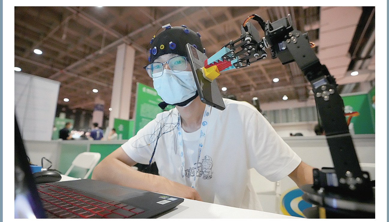
8月18日，工作人员在演示脑控机械臂拿手机。人的双手被占用时，可通过脑电信号控制机械臂拿东西。新华社发
