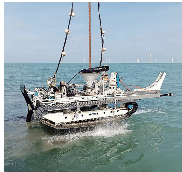
“水龙号”智能挖沟机准备下水作业。 企业供图
