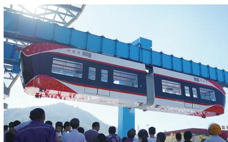
8月9日，国内首条稀土永磁磁浮轨道交通工程试验线——“红轨”，在江西兴国县正式竣工，并实现将稀土永磁磁浮技术与空轨技术结合，建成中低速、中低运量的新制式轨道交通系统。
