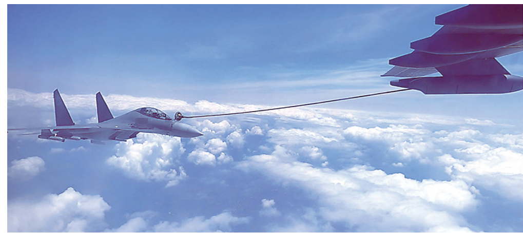
▲ 空军运油-20和歼-16飞机开展海上方向空中加油训练(资料照片)。据新华社
