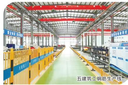
五建重工钢筋生产线
