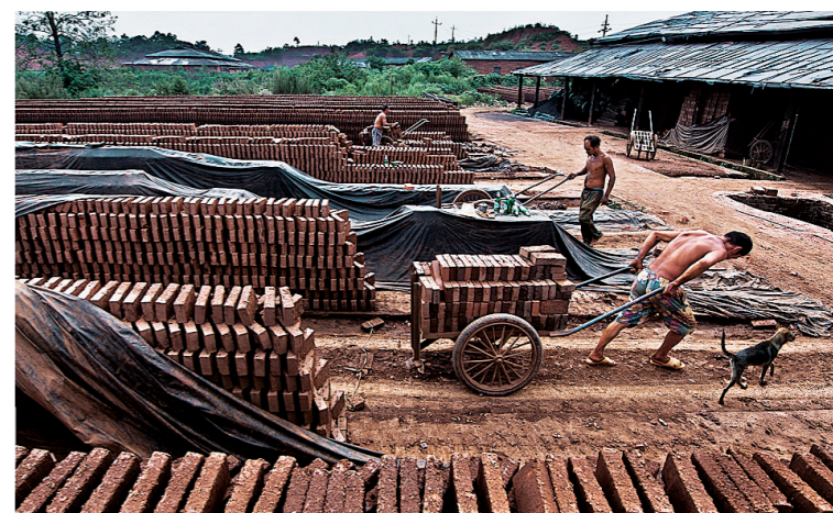
晒干的砖块,拖车进窑准备烧制。
