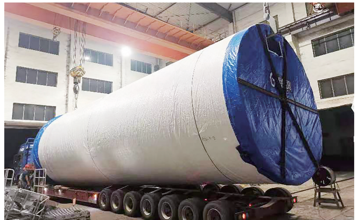
▲天桥起重生产车间内,正在装运的风电塔筒。企业供图
