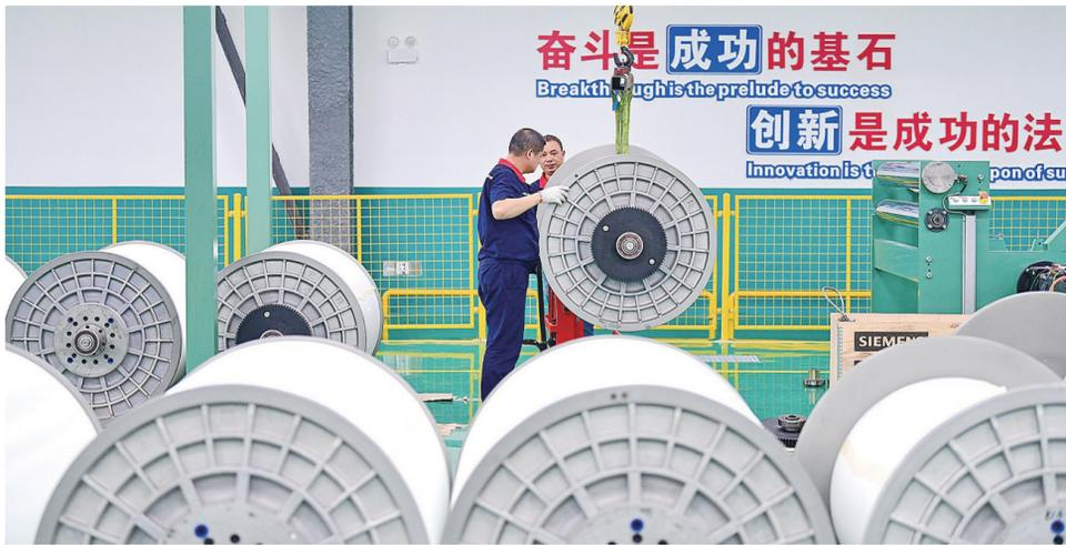
资料图：江西赣州，电子级玻璃纤维布生产线。
