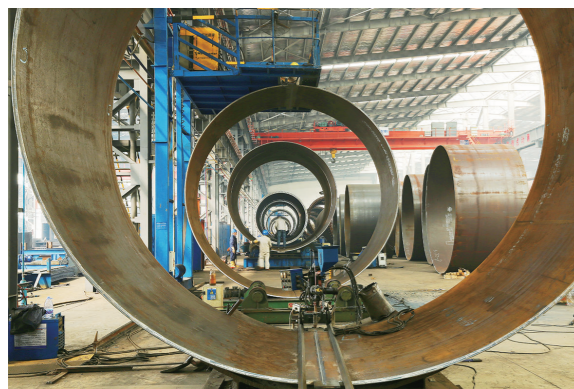
利德金属公司风机塔筒生产车间。
