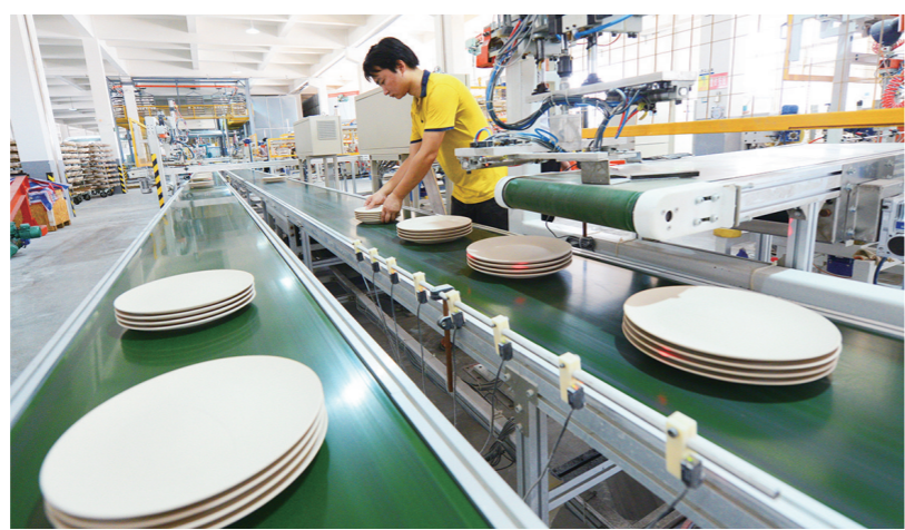
湖南玉祥瓷业有限公司的全省首条陶瓷等静压自动化生产线。 株洲日报全媒体记者/谭浩瀚 摄
