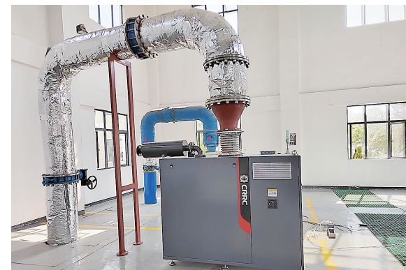
中车株洲电机公司研发的75kW气悬浮高速离心鼓风机。 企业供图
