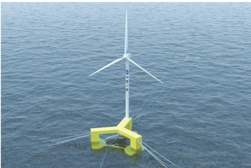
由中车株洲电机公司提供绿色动力的全球首台抗台风型漂浮式海上风电机组效果图。企业供图
