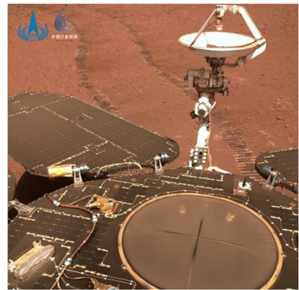
导航地形相机不同时期拍摄火星车本体影像:2022年1月22日(着陆后第247火星日),火星车表面存在明显的沙尘覆盖。(图片来源:国家航天局)
