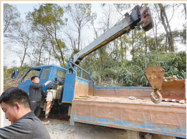
▲液压式吊臂,省去了很多搬运大树的力气。
