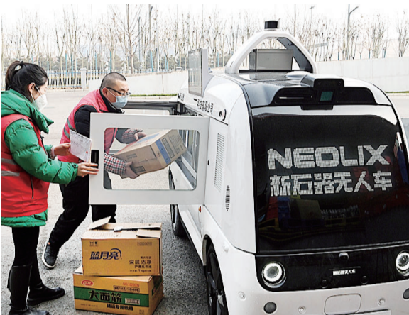
1月9日,在西咸新区沣西新城一物流中心,工作人员给无人配送车装货。 当日,陕西省西咸新区沣西新城作为试点区域开始用无人车提供物资配送,用于保障封控区人员基本生活物资供应。无人配送车在单程6.5公里的配送路线上,每天可配送物资6次,单次载重320公斤。 新华社记者 陶明 摄
