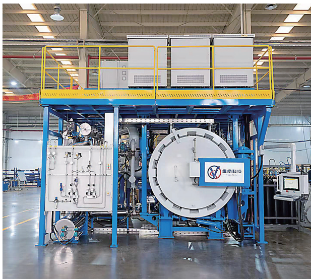
崔志文与团队研发的专用陶瓷压力烧结炉,技术国内领先。(受访者供图)
