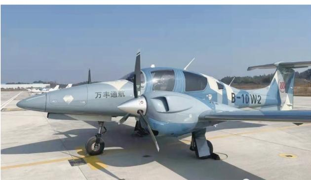
12月23日,国内唯一一架钻石DA62飞机从建德千岛湖机场起飞,于12时降落至株洲芦淞机场。这款由万丰飞机工业公司自主研发生产的七座双发螺旋桨复合材料DA62飞机,是国内唯一的一架。飞机配置自动驾驶、除冰、气象雷达、空速表等设备,是一款全天候通用飞机,适合于短途运输、商业包机、私人飞机、空中旅游等用途。
