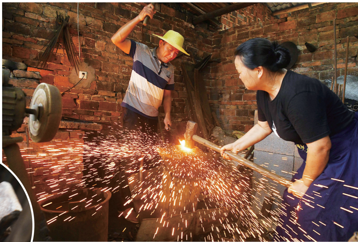
▲铁料出炉时锻打的头几锤,火花四射。
