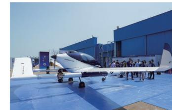
9月27日,一款专为城际空中交通设计的载人自动驾驶飞行器“亿航智能VT-30”亮相珠海。该机采用复合翼结构,两侧分布有8个螺旋桨,一对固定机翼,尾部设有推进螺旋桨,可容纳两名乘客。据介绍,该飞行器设计航程可达300公里,设计续航可达100分钟。图为在珠海拍摄的长航距载人自动驾驶飞行器。新华社记者/刘大伟 摄
