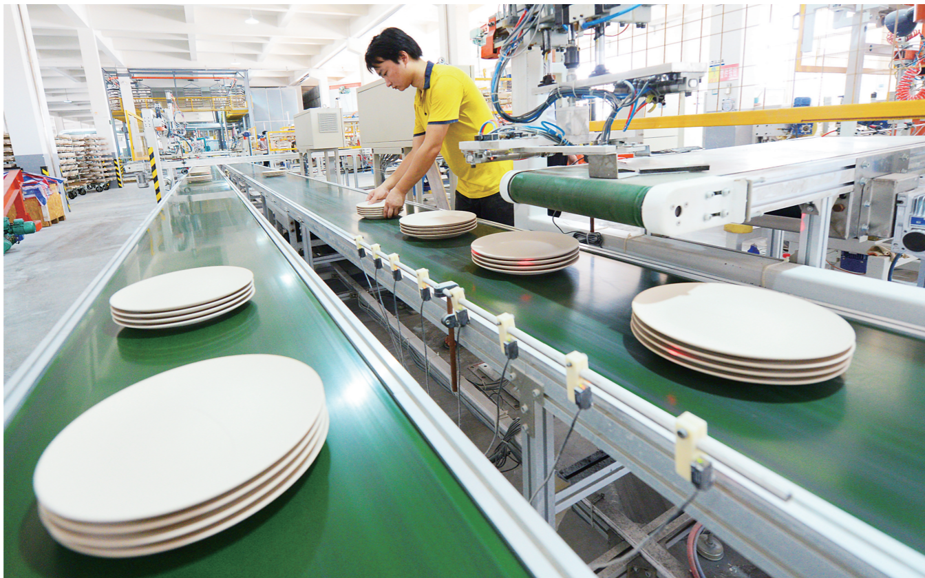
▲华瓷股份建设全省首条陶瓷等静压自动化生产线。资料图片
