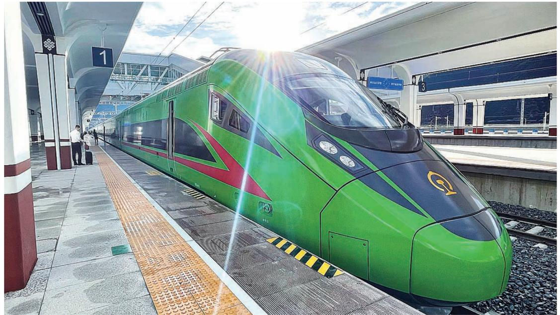
6月25日,“复兴号”高原双源动力集中型动车组从拉萨站驶出,在同日开通的西藏首条电气化铁路——拉林铁路上投入运营。这是由中国国家铁路集团牵头,中车株洲电力机车有限公司等多家轨道交通行业龙头企业及科研单位共同努力,以超强协作能力为庆祝建党百年献上的“贺礼”。中车株机公司副总工程师樊运新介绍,该动车组最高运行时速160公里,采用3动9拖编组型式,并可扩展到12拖,多项技术填补了行业空白,达到世界领先水平。该动车组的电力动力车为中车株机公司研制生产。(株洲晚报融媒体记者/高晓燕 通讯员/梁超 摄影报道)
