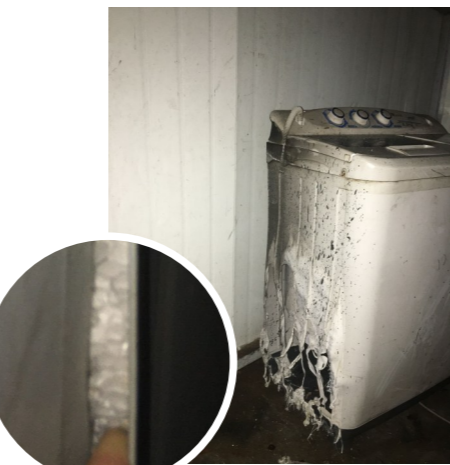
▲被烧坏的洗衣机(大图)。泡沫夹芯板房(小图)。
