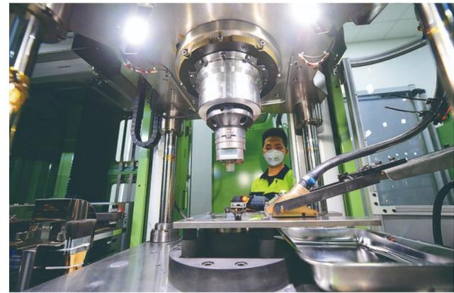
▲华锐精密车间内,自动化压机设备正在压制刀具毛坯。
