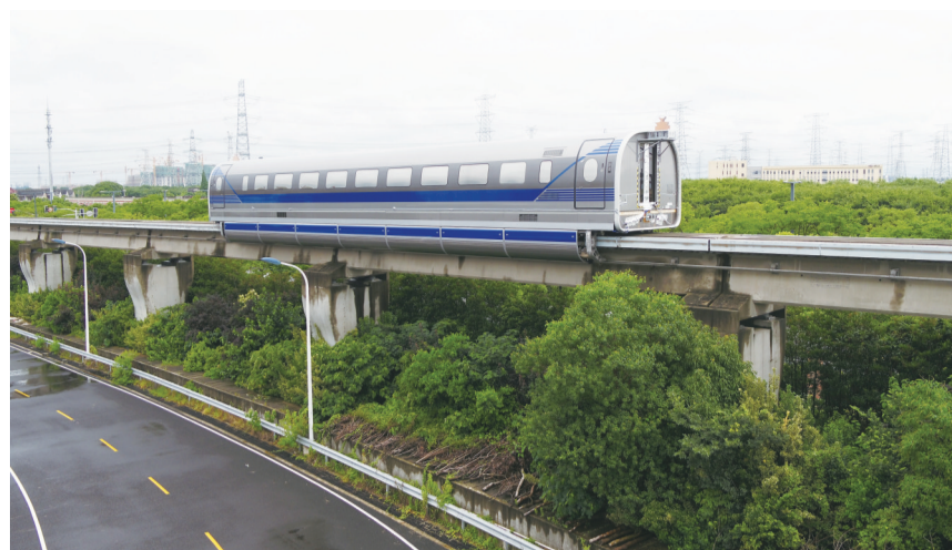
6月21日,时速600公里高速磁浮试验样车在磁浮试验线上试跑。新华社发
