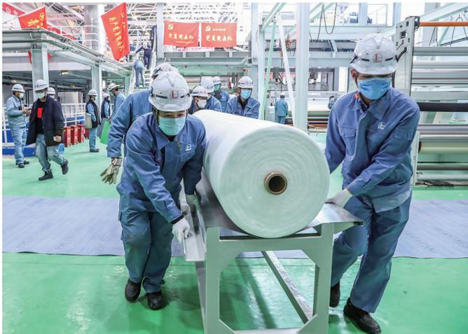
3月6日，在位于北京西部的中石化燕山石化厂区内，中石化和国机恒天集团合作建设的燕山石化熔喷无纺布生产线投入使用。该生产线年设计产能14400吨，包括两条熔喷无纺布生产线，3条纺粘布生产线。目前每天可生产4吨N95熔喷布或6吨医用平面
